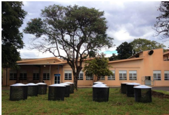
Figura 13 composteiras termofílicas em cilindros de polímeros
